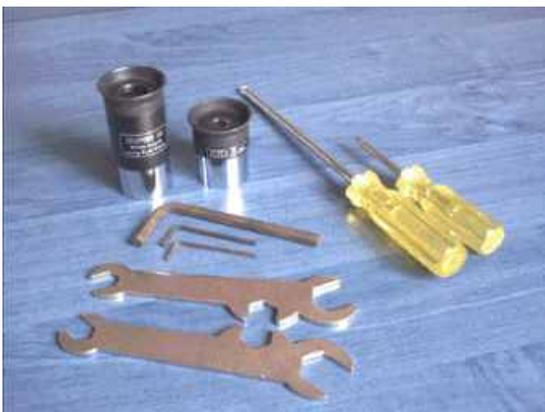
Telescopul vine dotat cu doua oculare (1,25”) „Super” de 10mm si 25mm care de fapt sunt niste Kellner (3 elemente) modificate cu campuri aparente de  $40^\circ$  si respectiv  $52^\circ$ . Din pacate acestea sunt total nepotrivite pentru un telescop cu focala asa de scurta. Imaginile prezinta distorsiuni destul de mari la marginea campului, vicii de refractie (efect „Seagull”), contrast slab.
