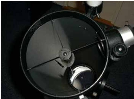
Bariletul pentru secundara este identic cu cel al telescopului Orion SkyQuest XT, cu surub central pentru reglarea inaltimii si trei suruburi Allen pentru pozitionare si ajustari de finete. Suportii bariletului (in numar de 3 dispusi la  $120^\circ$ ) sunt subtiri (sub 1 mm) astfel incat lumina poate ajunge fara obstructii prea mari la principala.
