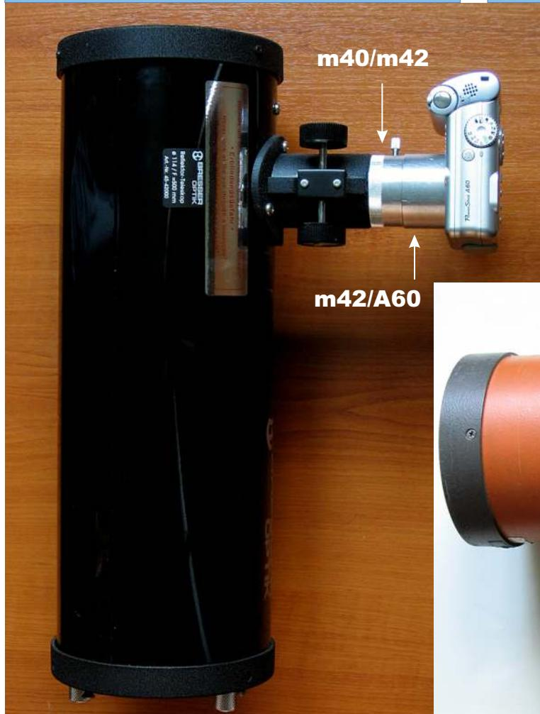
Ar fi bine ca, acolo unde se poate, aceste inele de adaptare să fie randalinate pe porțiuni 5mm. Evident la **1,25inch/m42** nu există loc de așa ceva. Nu am făcut desene pentru inele de macro deoarece ele sunt standardizate și se găsesc de vânzare la magazinele specializate în materiale fotografice.
